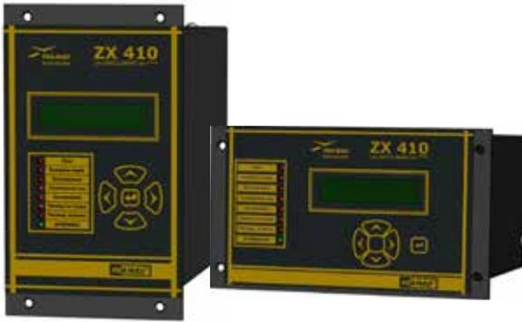
Устройства **PREMKO** серии **ZX 410** выполняют функции автоматического управления электроприводом РПН силового трансформатора под нагрузкой, а также имеют функцию дистанционного управления РПН с рабочего места диспетчера при включении устройств **ZX 410** в локальную сеть посредством порта RS-485.
